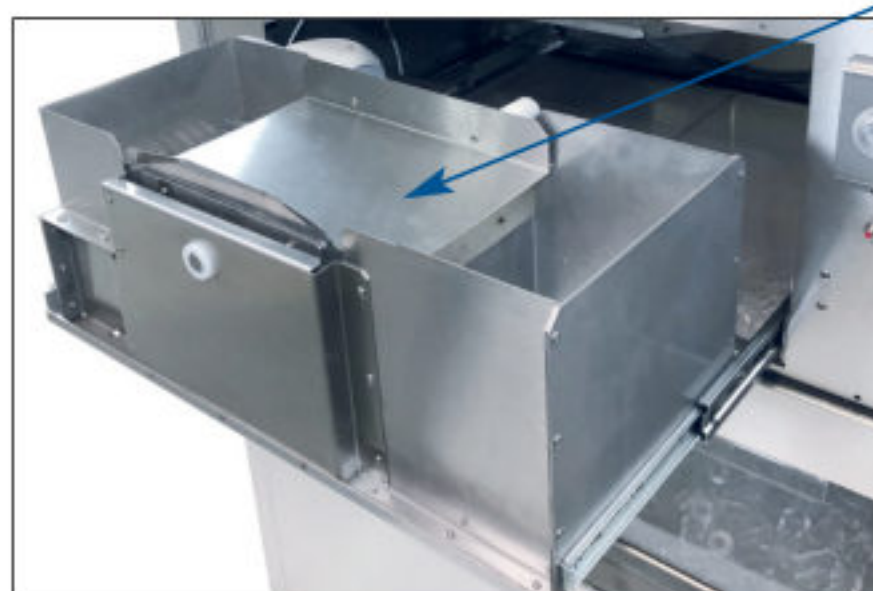
Den udtrækkelige glideanordning gør rengøring af crusher-modulet nemt.
