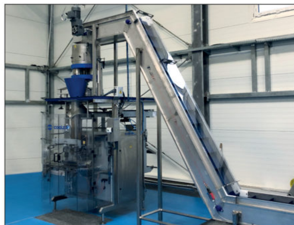
Individuelt designet WESSAMAT-transportørteknologi med automatisk påfyldnings- og pakkeenhed til isterninger og knust is.
