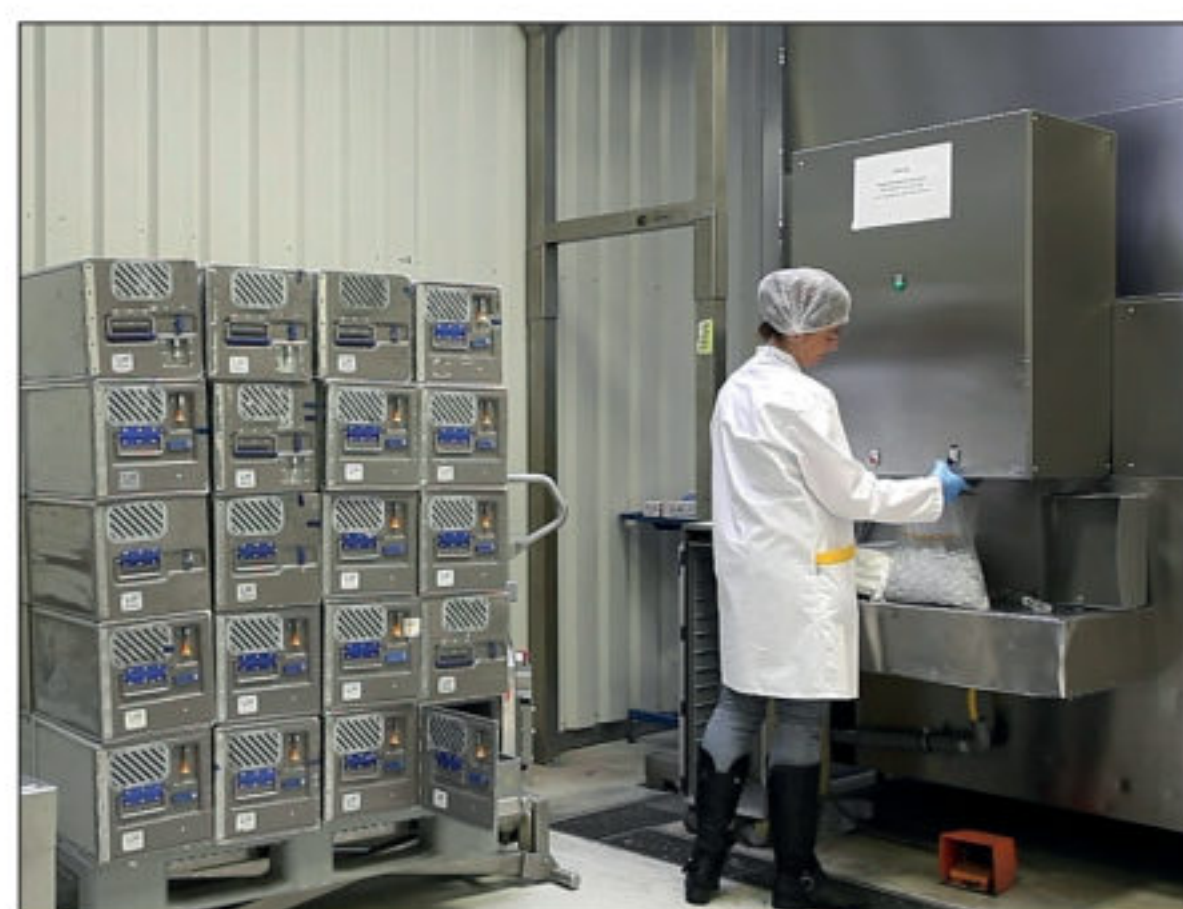
Isproduktion med halvautomatisk fyldning af hule isterninger til flyselskabers catering.
